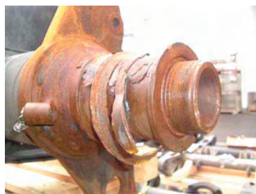
Bilde 11 I fravær av typeskiltet, er serienummeret preget inn i akseltappens ende.
