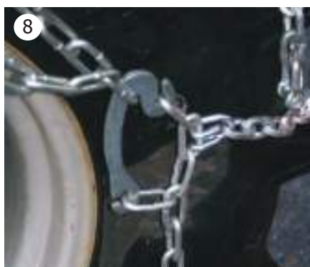
8 Stram kjettingene på hver side med låsearmen som vist. Husk å kutte sidekjettinglenkene som er for lange.
