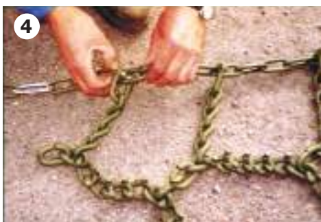
4 Monter sjaklene fra sjeksjonen til sidekjettingene.
