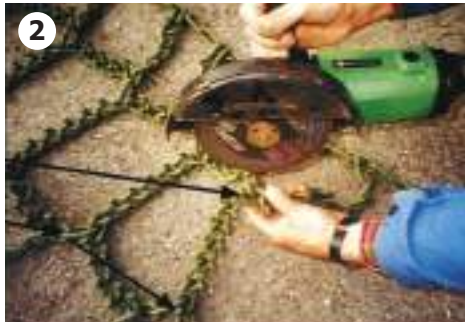
2 Bindeleddene på hver side av kjettingene kuttes med en vinkelsliper.
