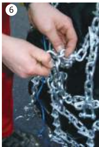
6 Frigjør kransen av skråskjærte koblingslenker.
