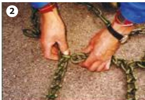
2 Monter sammen koblingslenkene på hver side.
