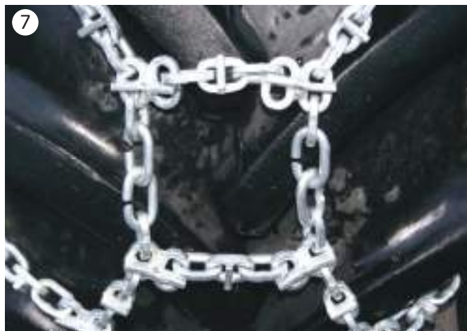
7 Koble sammen de skråskjærte koblingslenkene på hver side som vist.
