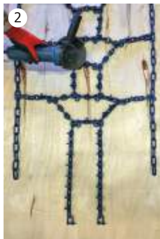
2 Kuttes på hver side for å ta bort en seksjon
