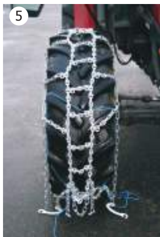
5 Stopp traktoren når kjettinglengdene møtes.
