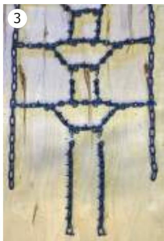
3 Etter å ha kuttet kjettingene på fire punkter tar vi bort den løse seksjonen og flytter endekjettingene en seksjon bakover ved punkt 2. Festes sammen med sveist dobbeltlenk med 2 stk. stiftkobling nr. 5 på hver side.
