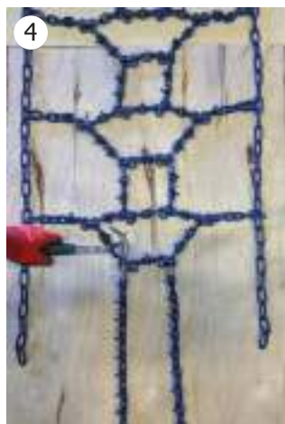
4 Samme framgangsmåte brukes ved å forlenge Easy On Lettkjetting med 1 seksjon, men her kutter vi bare endekjettingene og setter inn 1 stk. seksjon med 4 stk. stiftkoblinger nr. 5.
