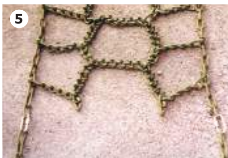
5 Kjettingene er forlenget med en seksjon, uten bruk av verktøy.
