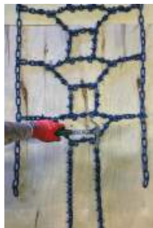
4 Samme framgangsmåte brukes ved å forlenge Easy On Lettkjetting med 1 seksjon, men her kutter vi bare endekjettingene og setter inn 1 stk. seksjon med 4 stk. stiftkoblinger nr. 5.
