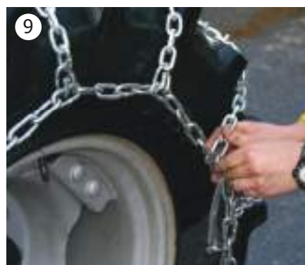
9 Fest siste nedtak til sidekjettingene på hver side med sjakel. Husk å skru sjaklene godt til før kjøring.
