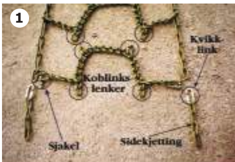
1 Komplett forlengessett til, i dette tilfellet OFA-traktorkjettinger, består av ett stykk seksjon med koblingslenker i begge ender, pluss to stykker sidekjettingbiter og to stykker kvikk link.
