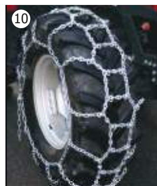
10 Lilleseth Lettkjetting 7mm ferdig montert.
