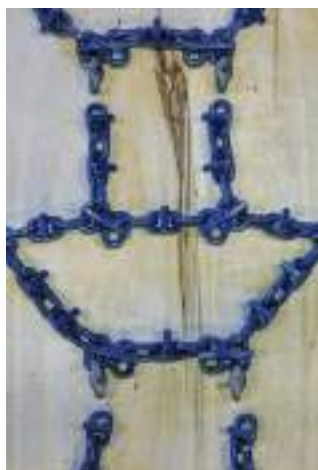
3 Etter å ha kuttet kjettingene på fire punkter tar vi bort den løse seksjonen og flytter endekjettingene en seksjon bakover ved punkt 2. Festes sammen med sveist dobbeltlenk med 2 stk. stiftkobling nr. 5 på hver side.
